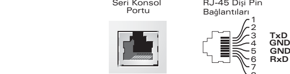
Şekil 4 Seri Port Pin Bağlantıları
